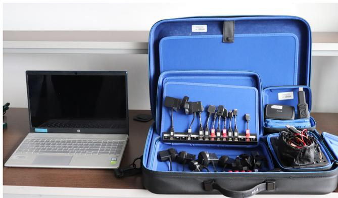
Estación para extracción de datos de dispositivos móviles XRY.
