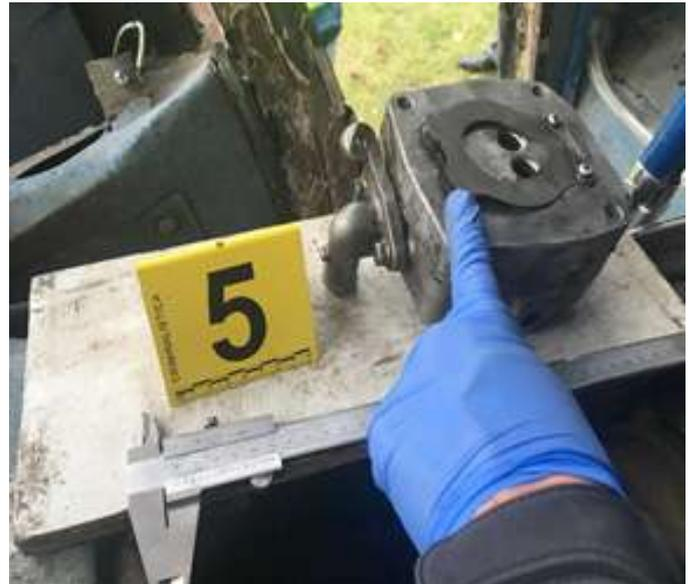
*Foto 4. Trabajo pericial en campo – Verificación de válvula de sección de compresor de aire.*
