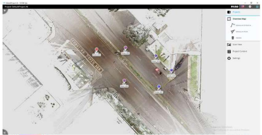
Foto 5. Plano utilizando el software SCENE de Faro.
