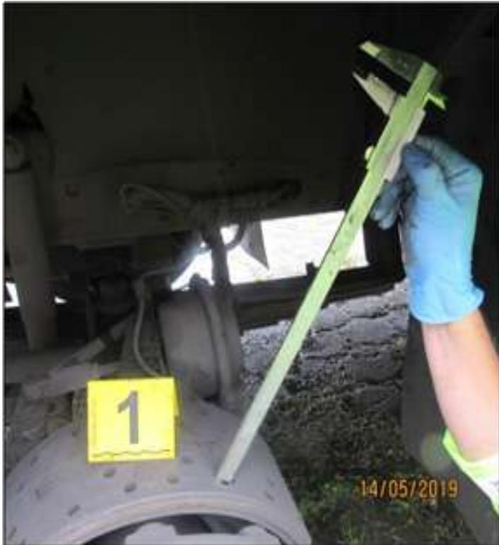
*Foto 3. Trabajo pericial en campo – Medición de espesor de zapata de freno.*
